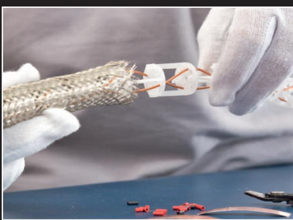
新的 RCA 連接頭包括幾個僅在組裝過程中使用的部件。首先，就像喇叭線一樣，交叉編織超高速波導的高純度銅線的薄漆塗層以機械方式去除；然後，碲銅連接端子引腳以 1.5 噸的壓力壓接到電線上。另一項創新是屏蔽連接，使用螺釘密封。
