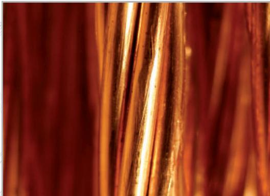
聲音信號的傳輸是極易受到干擾的，電阻、電感、電容、絕緣導電和集膚效應都會對聲音產生負面的影響。導體材料也是至關重要的，因為導體材料可以影響到電流的傳播，影響電導系數和背景噪音。這就是為什麼我們在 REFERENZ 線材上只使用高純度、具有高電導系數的無氧銅 ( OFC ) 。
