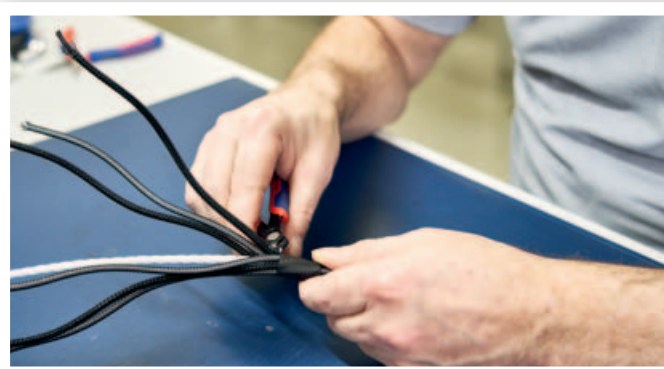
Im Finale braucht es die Hand. Die Kabel werden auf Maß geschnitten, der Kontakt freigesetzt und mit Schuh oder Stecker verbunden.
