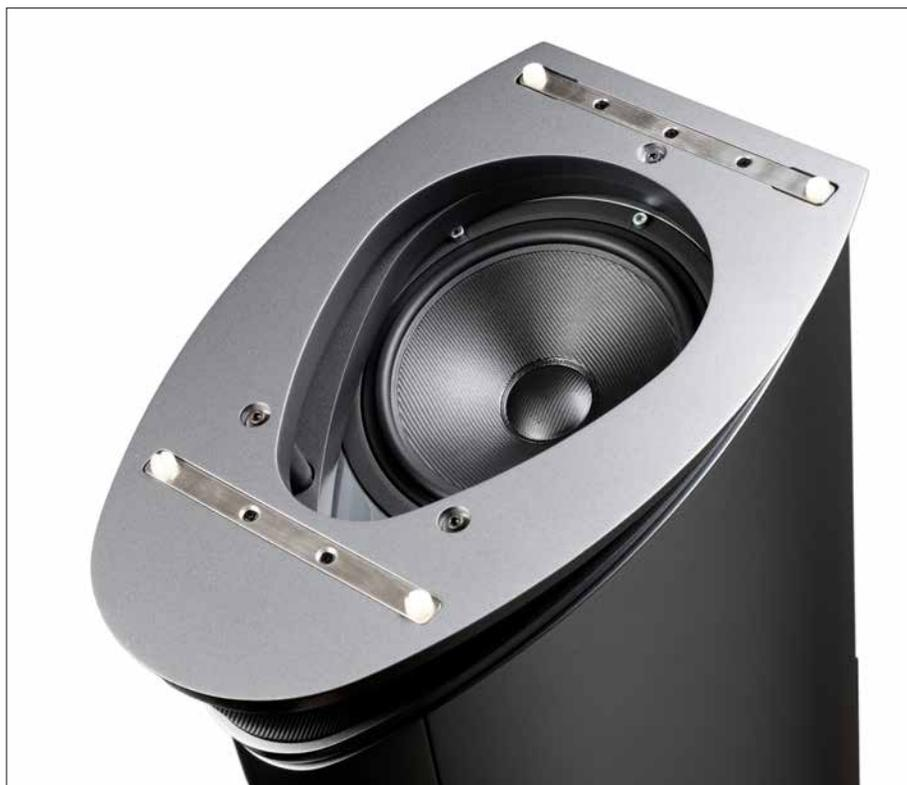
Unsichtbarer Doppel-Bass: Im Fuß aller R6-Varianten liegt ein Downfire-Subwoofer. Der ist im abgeschlossenen Gehäusesegment mit einem zweiten, kleineren Basstreiber gekoppelt, der Energie ins gemeinsame Volumen pumpt und den äußeren Woofer so mechanisch boostet.
