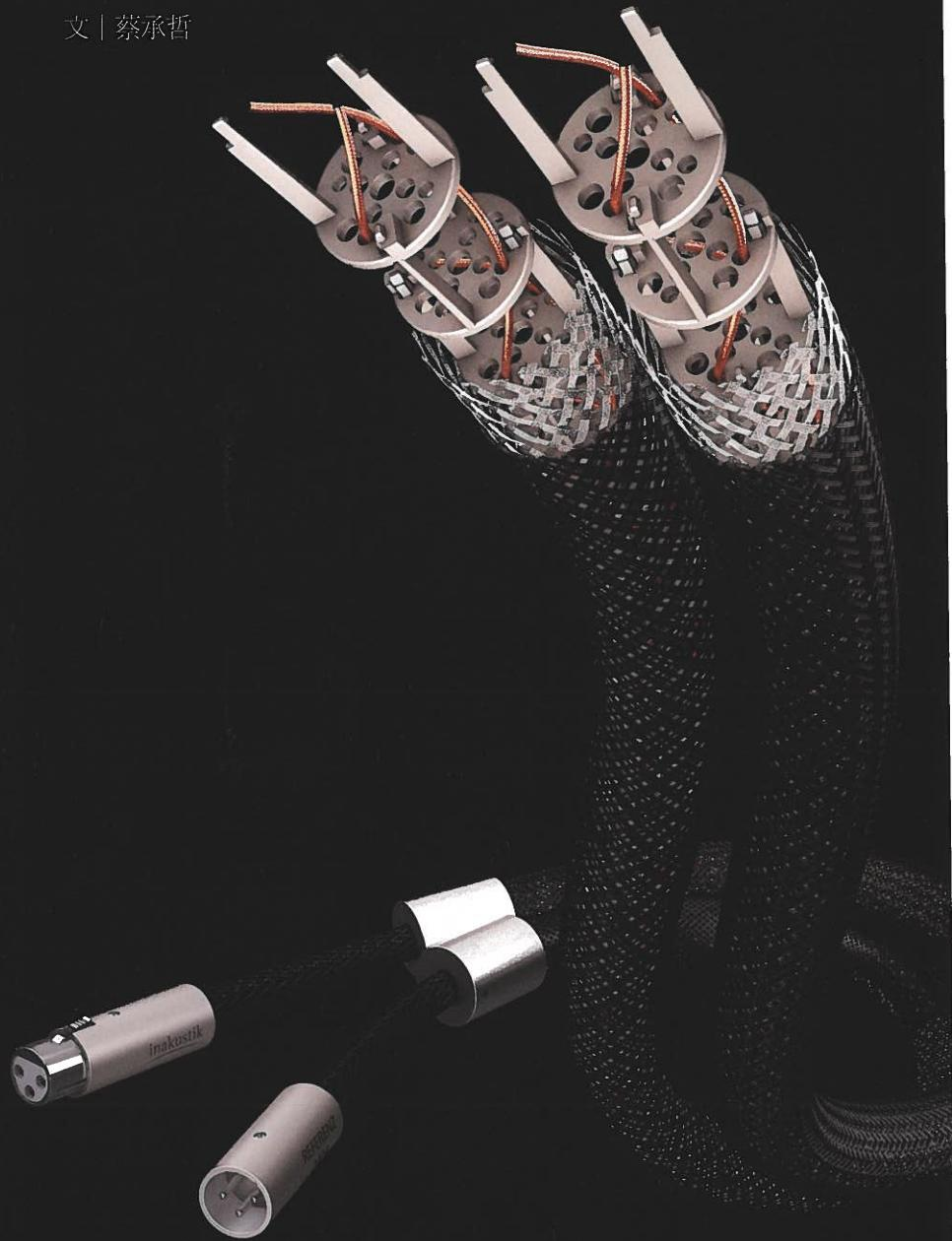
產品類型：訊號線。每股導體採用32根細銅絲圍繞PE管製成。採用獨家Air Helix結構。線身外側施以高純度無氯銅編織網，以及PE編織網。參考售價：XLR版83,000元（1.5公尺）。RCA版78,500元。（1.5公尺）進口總代理：鑑聲（02-28053569）。
