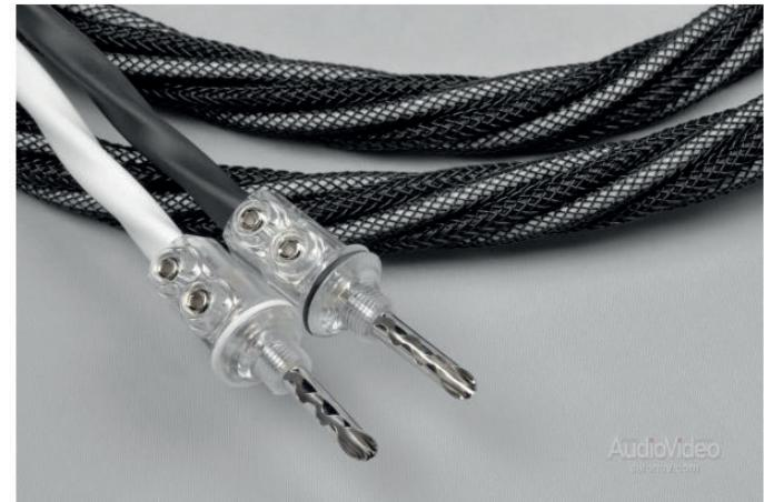
На все кабели ставятся фирменные разъемы в корпусах из поликарбоната, которые позволяют менять наконечники – «лопатки» или «бананы». Последние делаются из теллуриевой меди и покрываются родием.
