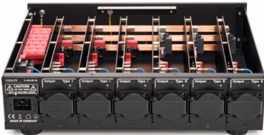
**ORDNUNG MUSS SEIN:** Insgesamt sechs Steckplätze stehen zur Verfügung, mit unterschiedlichen Filtertypen für analoge oder digitale Abnehmer.
