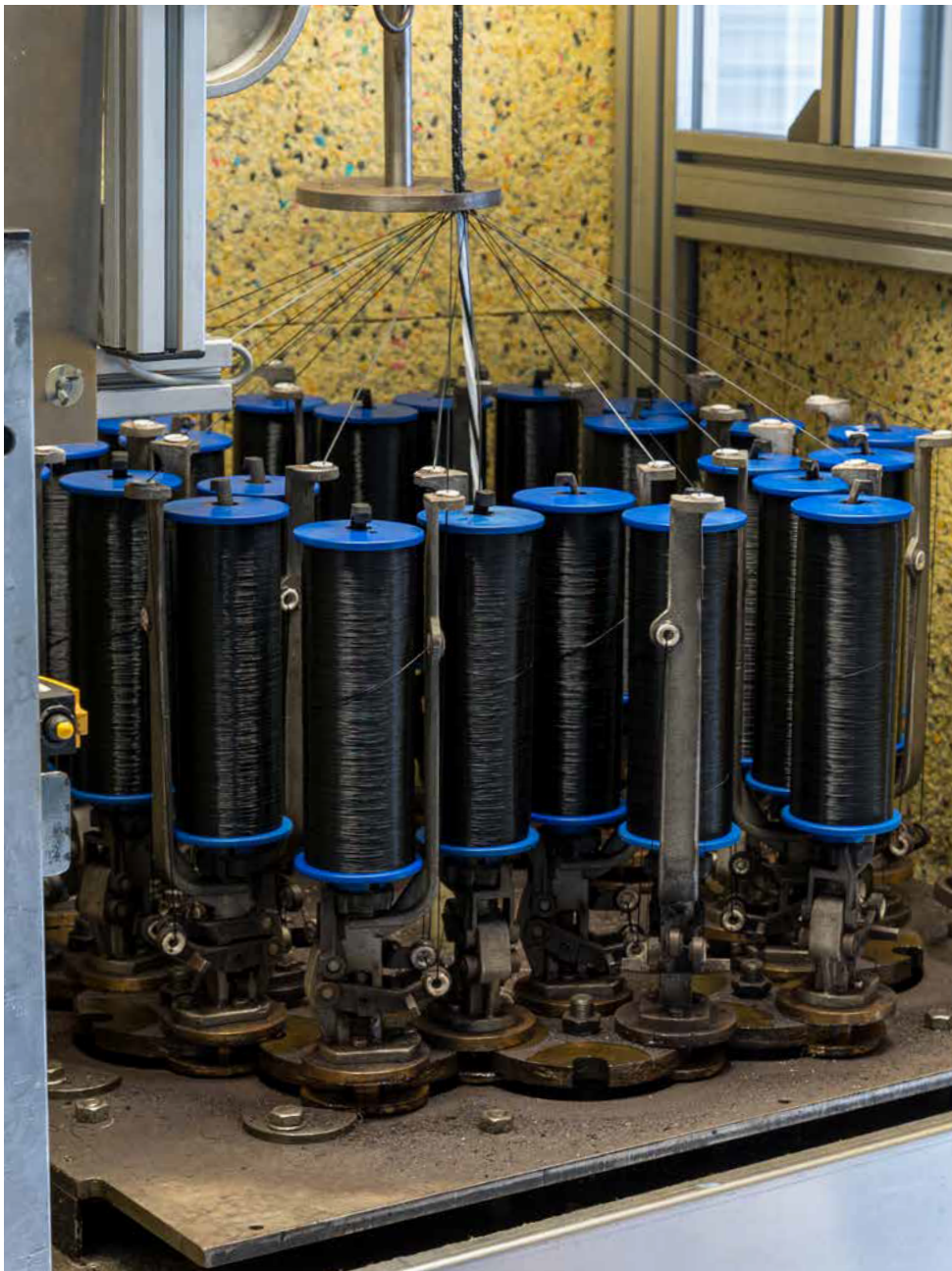
Die Firma in-akustik fertigt einen großen Teil der benötigten Teile selbst an. In den Bildern sehen Sie etwa die komplizierte „Webmaschine“, die Einzelleiter zu einem Kabel vereint, einen Industrielaser zur Beschriftung der Kabelkappen oder die Vorrichtung, in der die AIR-Kabel ihre Form und Helix erhalten.
